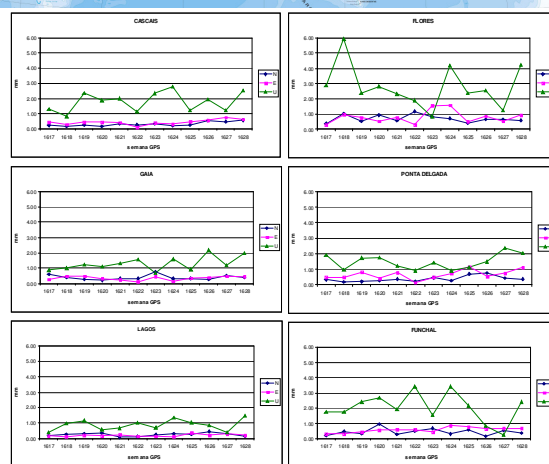
Figura 6 – Gráficos com a repetibilidade das coordenadas de cada uma das EP pertencentes à EPN nos meses de 2011. Efectuados com base nos dados disponíveis em http://www.epncb.oma.be .
